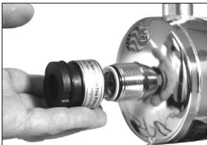
Step 4 - Remove Gland Nuts
